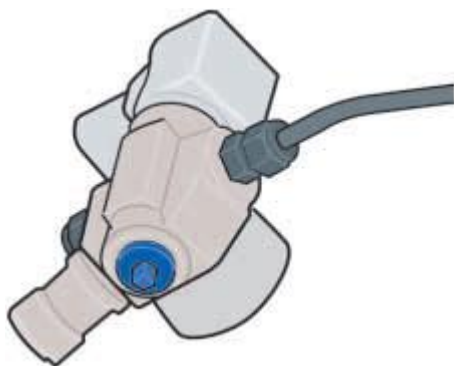
Ręczny zawór odcinający na zaworze głównym zbiornika
