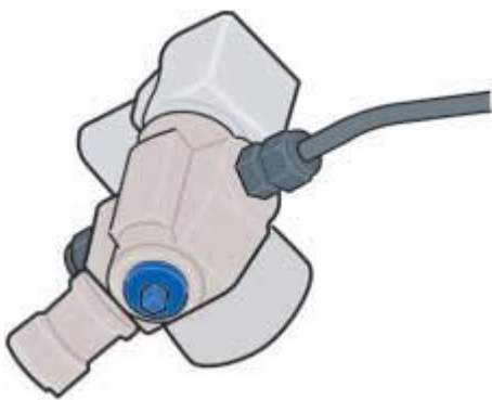
Ręczny zawór odcinający na zaworze głównym zbiornika
