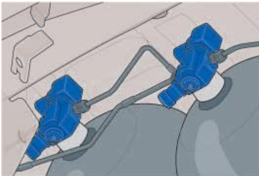
Elektromagnetyczne zawory odcinające na zbiornikach gazu
